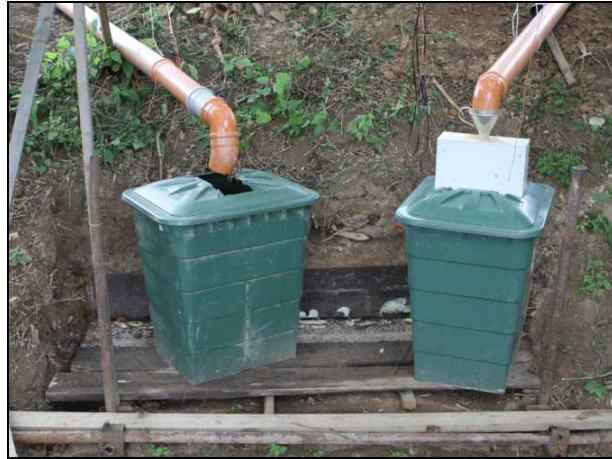
Obr.4 Sběrné nádoby pro experimentální plochy 1 a 3 byly umístěny blíže k experimentálním plochám
