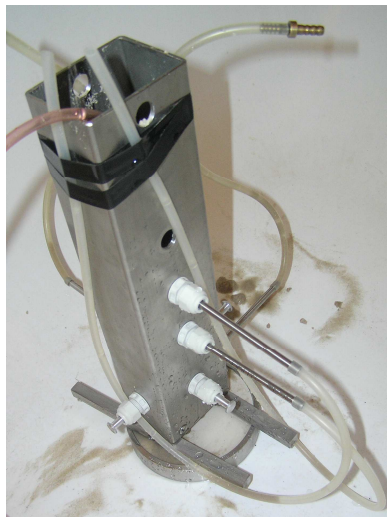
Obr.3 Jednoduchá aparatura pro měření průběhu tlaku vody v zemině
