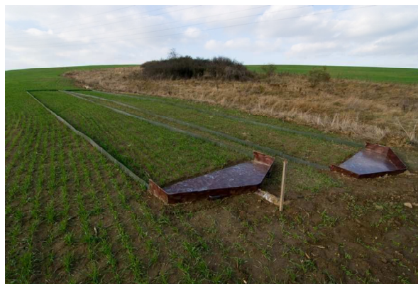
Obr.3 Instalace EEP II. se sběrnými díly pro zachycení erozních smyvů
