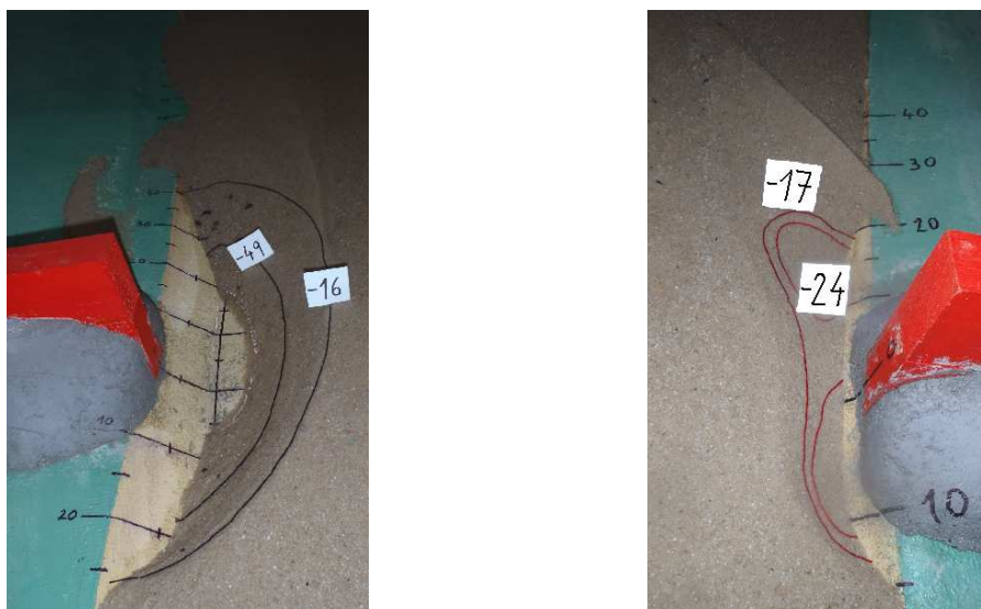
Obr.6 Výsledný reliéf písčného dna po průtoku 42.45 l/s (varianta 2). 1. foto – pohled po proudu, 2. foto – detail levého výmolu, 3. foto – detail pravého výmolu s vrstevnicemi a kótami [mm]
