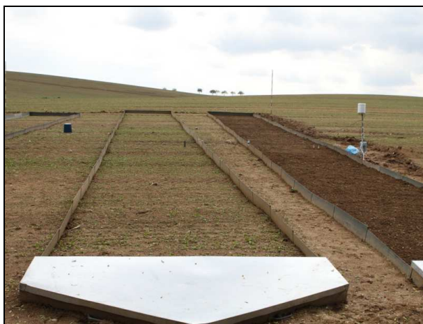
Obr.1 Experimentální plochy ohraničené ocelovými dílci
