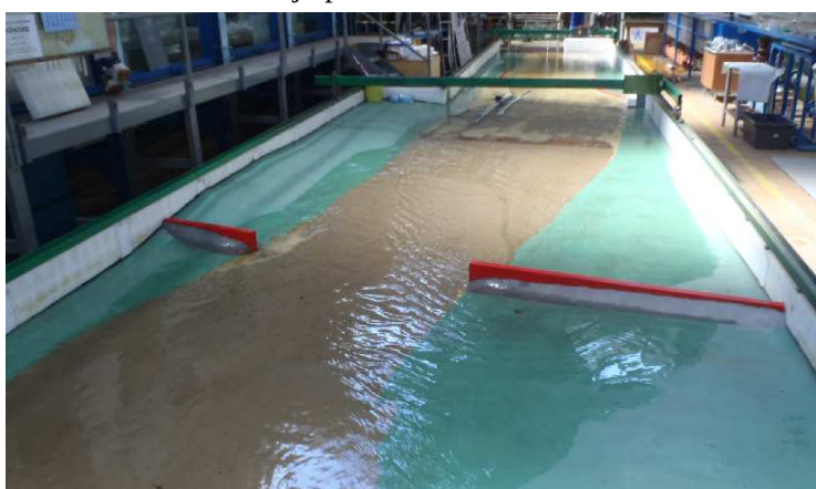
Obr.1 Říční model s mostními opěrami
