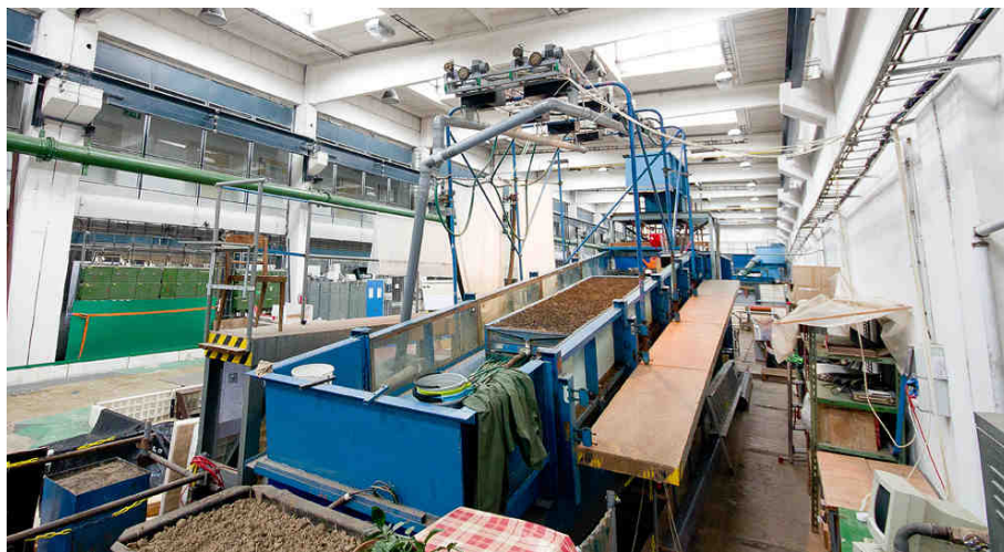
Obr. 1: Laboratorní dešťový simulátor KHMKI, ČVUT
