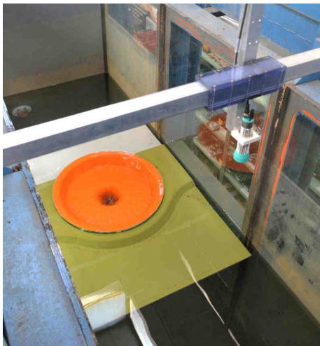
Obr. 2: Model umístěný ve žlabu s čidlem snímajícím výšku hladiny
