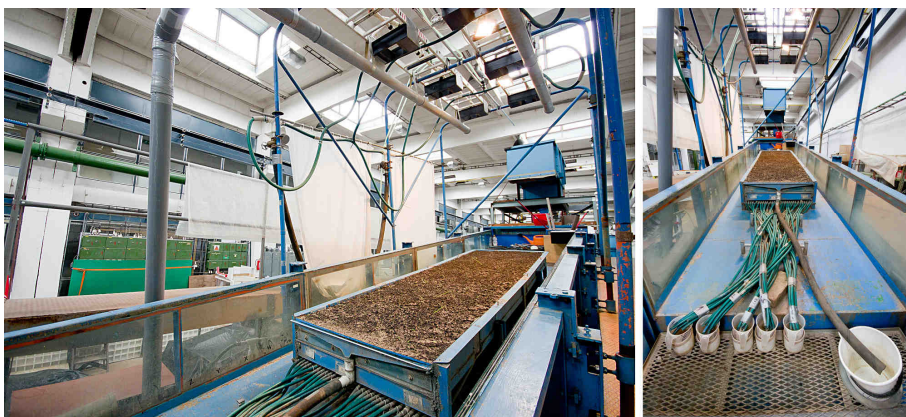
Obr. 1: Laboratorní dešťový simulátor KHMKI, ČVUT
