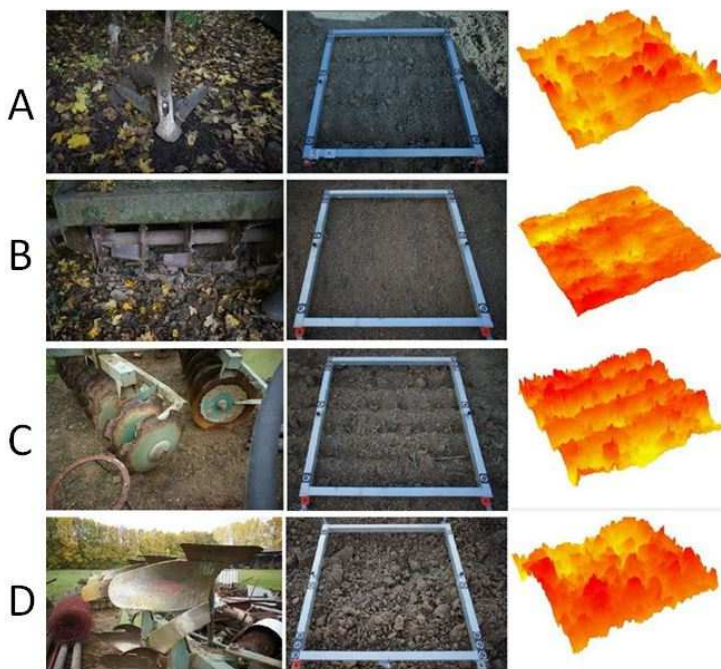
Obr. 1: Testované plochy A-D: použitá mechanizace obdělání – fotografie terénu – 2x převýšený DMT [4]
