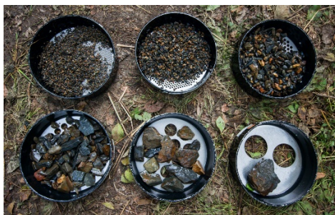
Obr. 2: Zůstatky na sítích s kruhovými otvory
